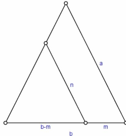
Por semejanza de triángulos:  $\frac{a}{n} = \frac{b}{b-m} \rightarrow n = \frac{a}{b} \cdot (b-m)$
