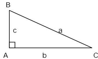
Aunque en general se suele utilizar el teorema de Pitágoras sólo para aplicar la igualdad, también se puede emplear para demostrar que un triángulo es rectángulo comprobando que sus lados verifican la relación.
